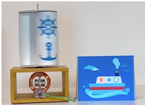
発電の様子(しくみが全部見える発電機)
