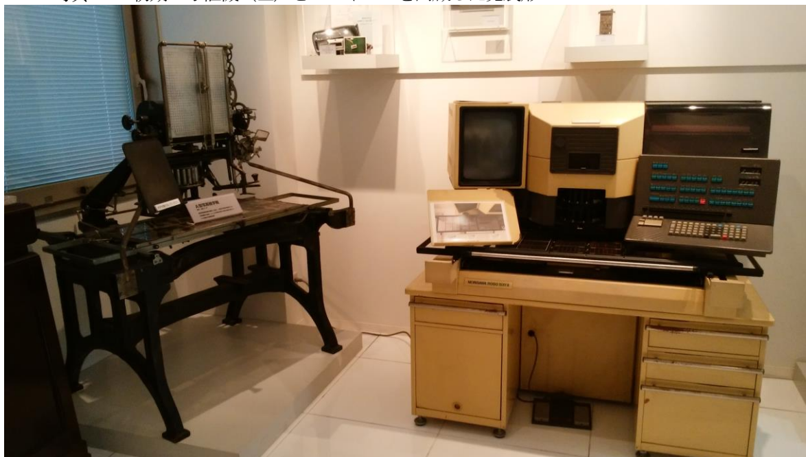
写真1 初期の写植機（左）と マイコンを内蔵した発展形
