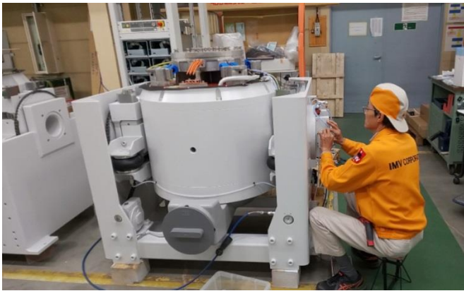
振動試験装置組立て
