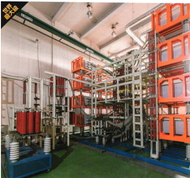
22 万 A インパルス電流発生装置
