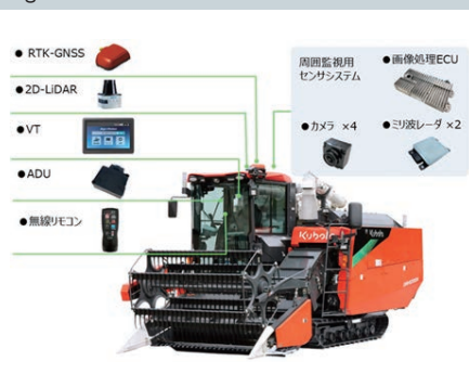
Fig.1 自動運転コンバインシステム構成
