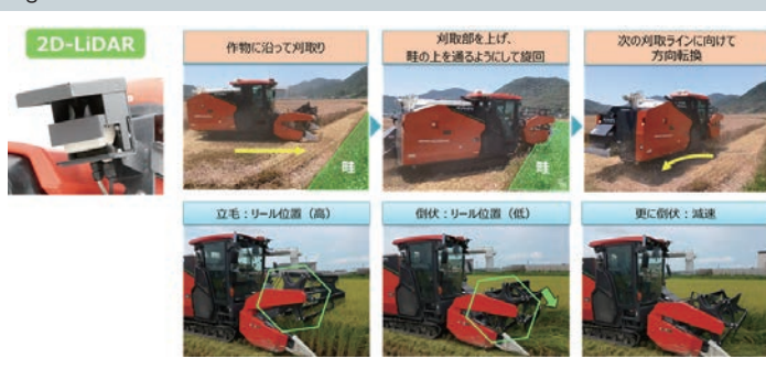
Fig.3 圃場の畦や作物の高さに応じた自動運転
